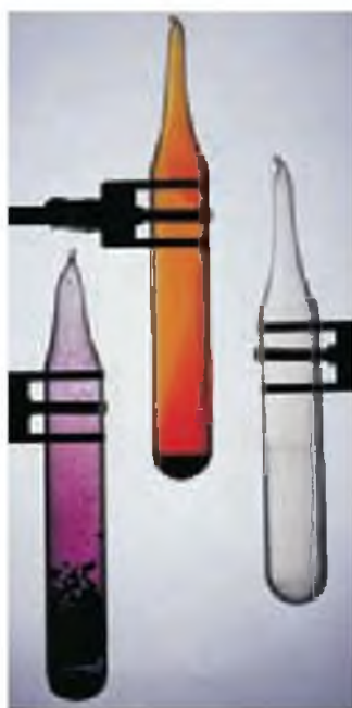
▲ Figura 7.35 Halógenos elementales. Estos tres elementos [de izquierda a derecha, yodo ( I_2 ), bromo ( Br_2 ) y cloro ( Cl_2 )] existen como moléculas diatómicas.
